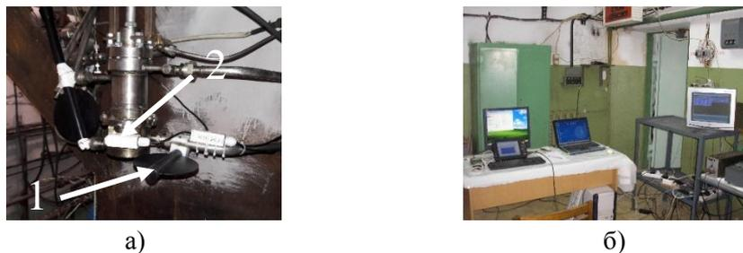
Рис. 1. Расположение датчиков на модельном ЖРД и система управления измерениями
