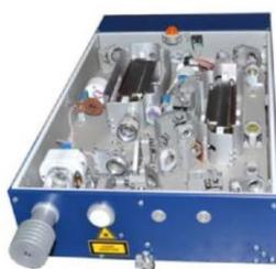
**Мощный TEM<sub>00</sub> Nd:YAG лазер** с шириной линии генерации **<0.1 см<sup>-1</sup>**, малой расходимостью **<0.25 мрад** и энергией импульса до **700мДж** на длине волны 1064нм. По Вашему желанию лазер может быть дополнен встроенными или внешними генераторами гармоник вплоть до **213нм**;
